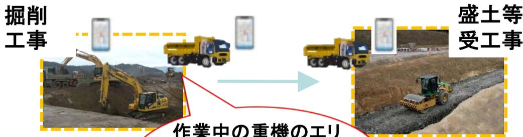
作業中の重機のエリアからダンプが離れると一定の土量をカウントする仕組み
