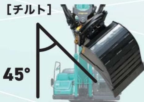
これまでバックホウで掘削できなかった箇所(人力作業)でもバケット向きを変えられるため、掘削が可能となった。
