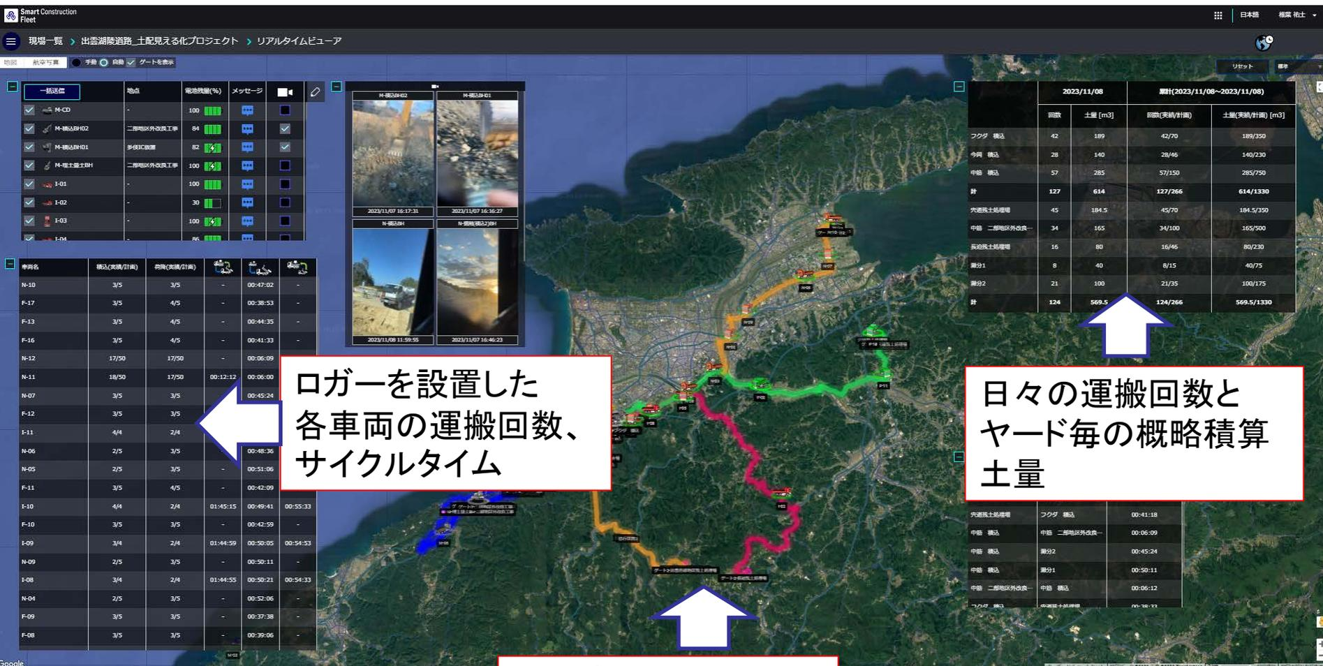
ロガーを設置した各車両の運搬回数、サイクルタイム
